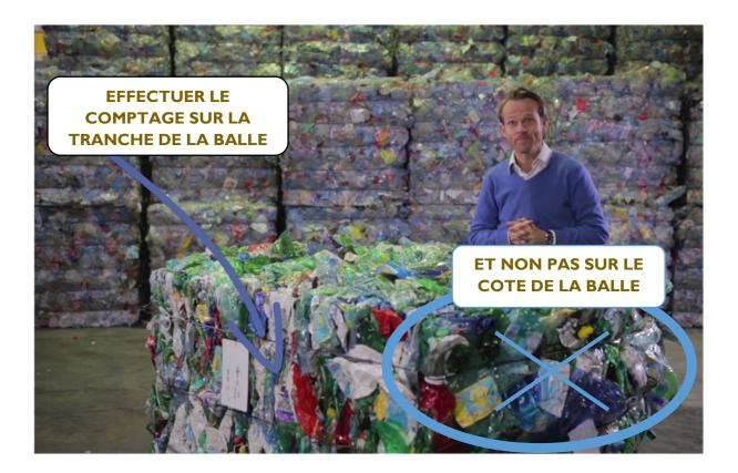
Selon la séquence de pressage, si 2 balles du même flux sont réalisées consécutivement, le contrôle peut être effectué sur une tranche de chacune des 2 balles.
